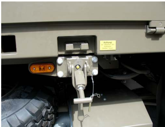
Abb. 7+8: Warnsignale und Sensoren informieren, falls Verriegelung offen
