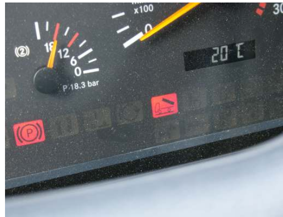
Abb. 7+8: Warnsignale und Sensoren informieren, falls Verriegelung offen
