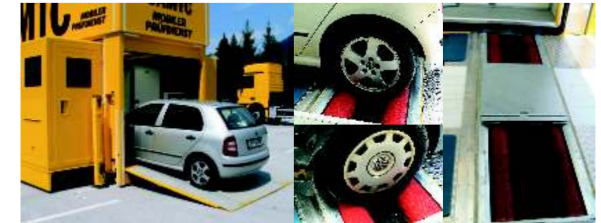
Zusätzliche Eingangstür, Einfahrrampe und Bremsenprüfstand Additional Entry, hydraulic platform and test bench for brakes
