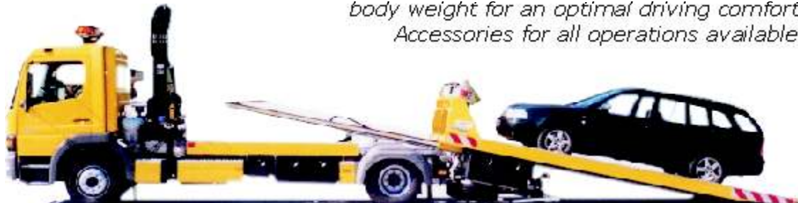
Schiebeplateau mit Kran und hydraulischem Unterlift (PKW Brille) Sliding platform with crane & hydr. operated rear towing equipment (underlift system)
