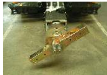
speziell entwickeltes pendelbares Hubjoch für Off-Road-Einsätze
