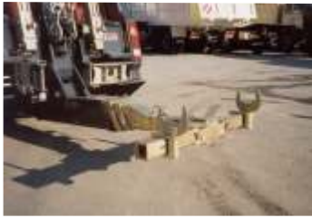
Verstellbare Hubgabeln in verschiedenen Größen
